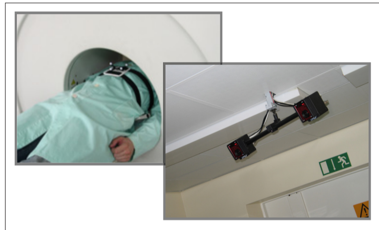
Abb. 1: Die Abbildung zeigt rechts das Bewegungsverfolgungssystem. Es detektiert die Bewegung eines auf der Brust des Patienten fixierten infrarotlicht-reflektierenden Targets (links).
